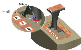
图3: 使用单极性开关的应用: 换挡过程中, 当磁体 (红色和蓝色圆柱体) 经过C时, 开关动作
